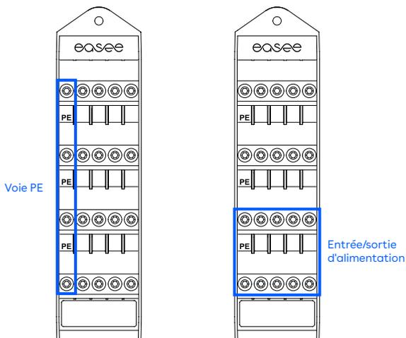
Nous vous recommandons d'utiliser les deux jeux de bornes supérieurs pour les câbles du chargeur.
