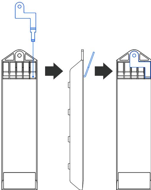
2. Insérez la rondelle crantée sur la tige à l'intérieur de la colonne. Elle doit être placée entre la colonne métallique et le Power Rail.
